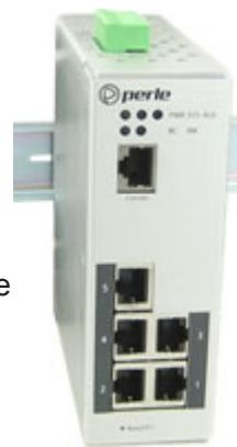
Der IDS-205 ist ein **Managed Ethernet Switch mit 5 Ports**, der in **industriellen 10/100/1000-Base-T-Umgebungen betrieben werden kann**, eine erweiterte Leistung bietet und einen **deterministischen Netzwerkbetrieb in Echtzeit ermöglicht**.
