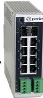
Der IDS-710HP ist ein Managed Ethernet Switch mit 10 Ports, der in industriellen Umgebungen betrieben werden kann, eine erweiterte Leistung bietet und einen deterministischen Netzwerkbetrieb in Echtzeit ermöglicht. Für die Vernetzung von Gigabit- und Fast-Ethernet-Geräten stehen acht 10/100/1000-Base-T-Ethernet-Ports zur Verfügung. Die beiden SFP-Steckplätze unterstützen 10/100/1000 auf Kupfer oder 1G/2,5G auf Glasfaser.
