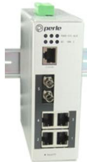
Der **IDS-305 G** ist ein **Managed Ethernet Switch mit 5 Ports**, der in **industriellen Umgebungen betrieben werden kann**, eine erweiterte Leistung bietet und einen **deterministischen Netzwerkbetrieb in Echtzeit** ermöglicht. Für die Vernetzung von Gigabit- und Fast-Ethernet-Geräten stehen vier 10/100/1000-Base-T-Ethernet-Ports zur Verfügung. Eine 1000Base-X-Glasfaserverbindung ist verfügbar, um die **Gigabit-Ethernet-Betriebsentfernung über Glasfaser zu erweitern**.
